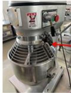
攪拌開始防護網確實扣住安全裝置.,
